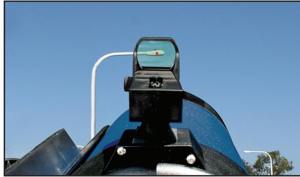
Der Leuchtpunktsucher wurde bereits während der Herstellung justiert. Dennoch ist es möglich, dass in manchen Fällen eine Korrektur von Nöten ist. Schauen Sie hierfür durch das Okular Ihres Teleskops und verwenden Sie die Handsteuerbox, um einen weit entfernten Referenzpunkt zentral im Gesichtsfeld zu positionieren. Schalten Sie nun den Leuchtpunktsucher
