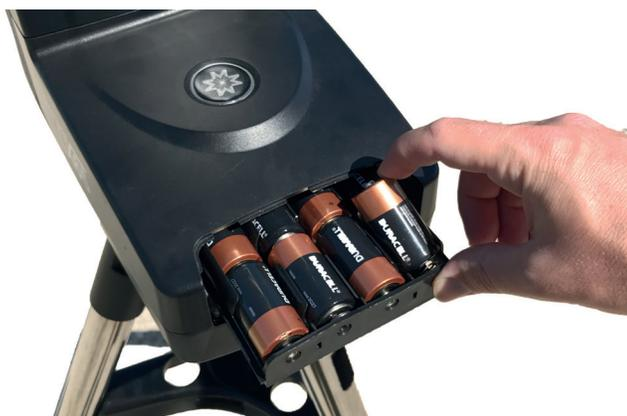
**6** Entfernen Sie nun die Abdeckung des Batteriefachs und ziehen Sie dieses vorsichtig bis zum Anschlag heraus. Legen Sie acht Alkaline "C" Batterien (nicht im Lieferumfang enthalten) in das Batteriefach. Geben Sie darauf Acht, dass die + und - Pole der Batterien in die vorgesehene Richtung weisen. Schieben Sie das Batteriefach zurück und bringen Sie die Abdeckung wieder an.
