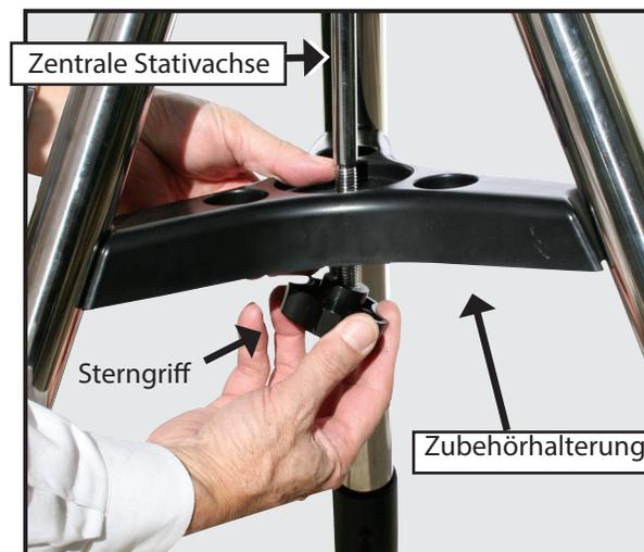
Entfernen Sie den Sterngriff am unteren Ende der zentralen Stativachse. Schieben Sie nun die Zubehörhalterung auf die Stativachse und befestigen Sie den Sterngriff. Drehen Sie diesen so lange, bis sich die Zubehörhalterung sanft an die vollständig geöffneten Stativbeine drückt. Stellen Sie das Stativ nun an den von Ihnen gewünschten Ort und kontrollieren Sie mittels einer Wasserwaage, ob sich die obere Fläche des Stativs in einer ausgeglichenen Position befindet.
