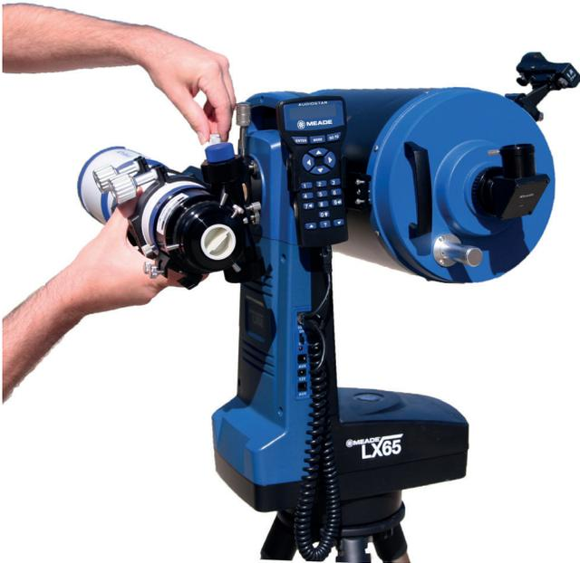
Das LX65 ist mit einer zweiten Schwalbenschwanzklemme ausgestattet, was das Anbringen eines weiteren Teleskops erlaubt. Dieses benötigt eine passende Vixen-Style Prismenschiene, um am LX65 befestigt werden zu können. Das Maximalgewicht für die Zweitoptik liegt bei 3,2kg.
