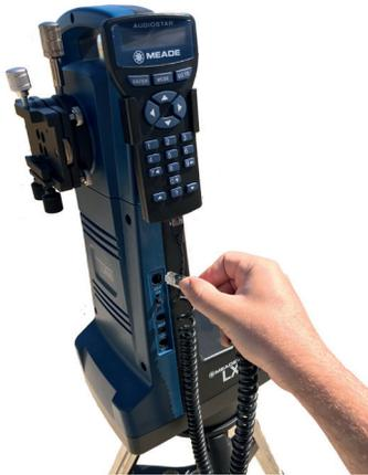
8 Stellen Sie sicher, dass sich der Einschaltknopf auf Off befindet. Entnehmen Sie nun die Handsteuerbox mitsamt dem Spiralkabel. Verbinden Sie das passende Ende des Kabels mit der HBX Buchse der Teleskopschaltstelle. Das andere Ende des Kabels wird in der dafür vorgesehenen Öffnung der LX65 Handsteuerbox eingesteckt.
